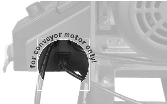
THE OUTLET ON THE CONTROL BOX IS FOR THE CONVEYOR MOTOR PLUG ONLY. DO NOT USE THIS OUTLET FOR ANY OTHER PURPOSES!
