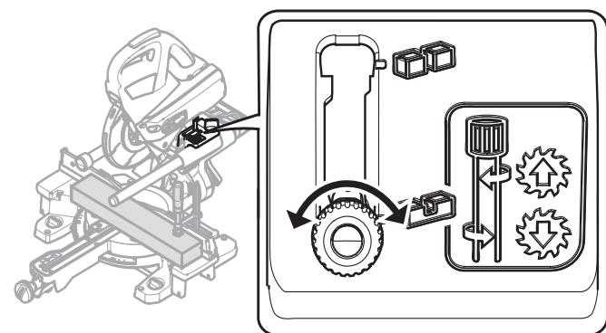
**i** Перекидывайте рычаг ограничения глубины выборки паза **[1-4]** только тогда, когда пила находится в верхнем положении (= рабочее положение).
