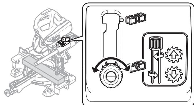
❷ Hebel für Nuttiefenbegrenzung **[1-4]** nur umklappen, wenn das Sägeaggregat in der oberen Position (=Arbeitsposition) ist.
